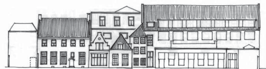
Afb. 16b Tivolicomplex ,tuinzijde, gevelreconstructietekeningen van de verschillende bouwfases, getekend door Frans Kipp na bouwhistorisch onderzoek in 1983. (R.O.V.U. Bureau Monumenten)
