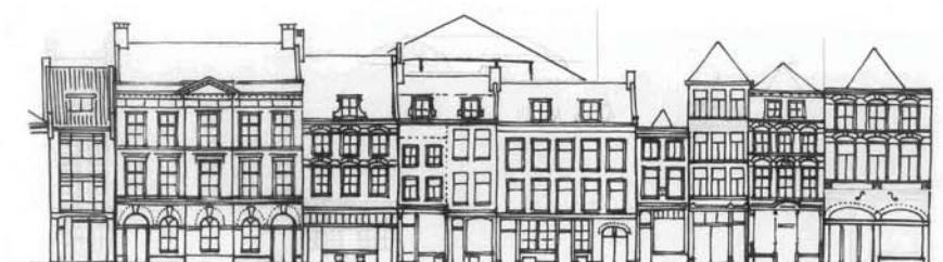
Afb. 16a Tivolicomplex, Oudegrachtzijde, gevelreconstructietekeningen van de verschillende bouwfasen, getekend door Frans Kipp na bouwhistorisch onderzoek in 1983. (R.O.V.U. Bureau Monumenten)
