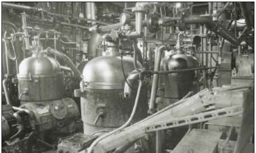
34. Het interieur van het extractiegebouw met de centrifuges, 2002. (Bron: HUA)
