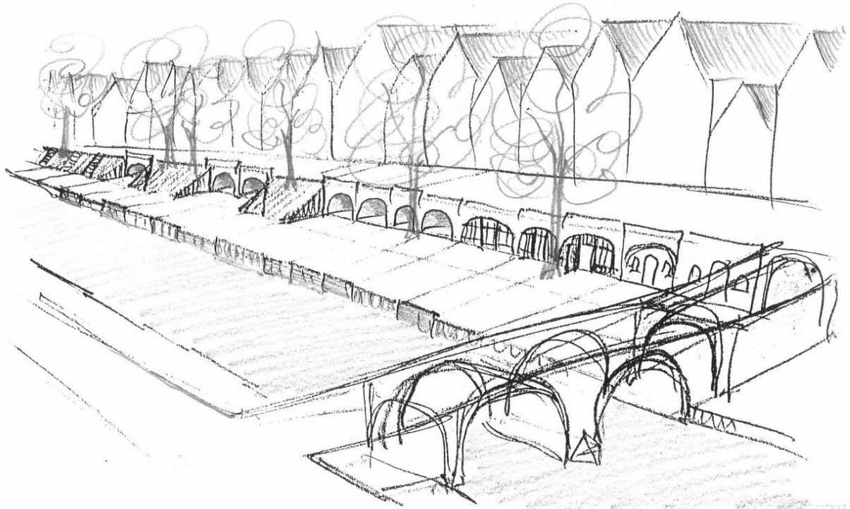
6. Schets van de ontwikkeling van werven, werfkelders en werfmuren in de loop der eeuwen. Tijdsverloop van links (12 e eeuw) naar rechts (19 e eeuw) (F.K.)
