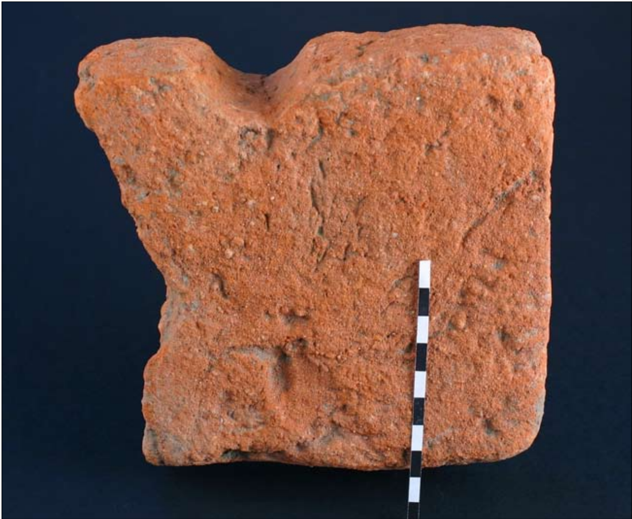
4.5 Bakstenen spitoplegger, waarschijnlijk vroeg-dertiende-eeuws. De halfronde inkeping aan de bovenkant is duidelijk vóór het bakken in de nog zachte klei aangebracht, wat betekent dat het hier geen later aangepaste kloostermop betreft. Fotografie: Hans Lägers.
