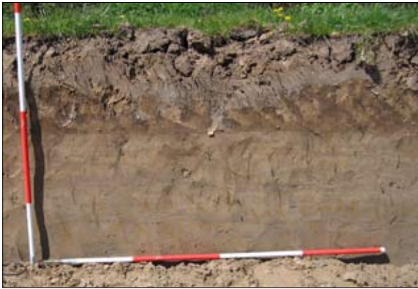
Afb. 2.3 Westelijke profielwand van werkput 1 waarin de horizontale gelaagdheid in het zand zichtbaar is.
