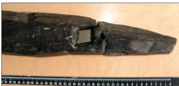
Afb. 13.7 De gaten in deze balk zijn waarschijnlijk voorgeboord en vervolgens met een guts vierkant gemaakt (vnr. 383).
