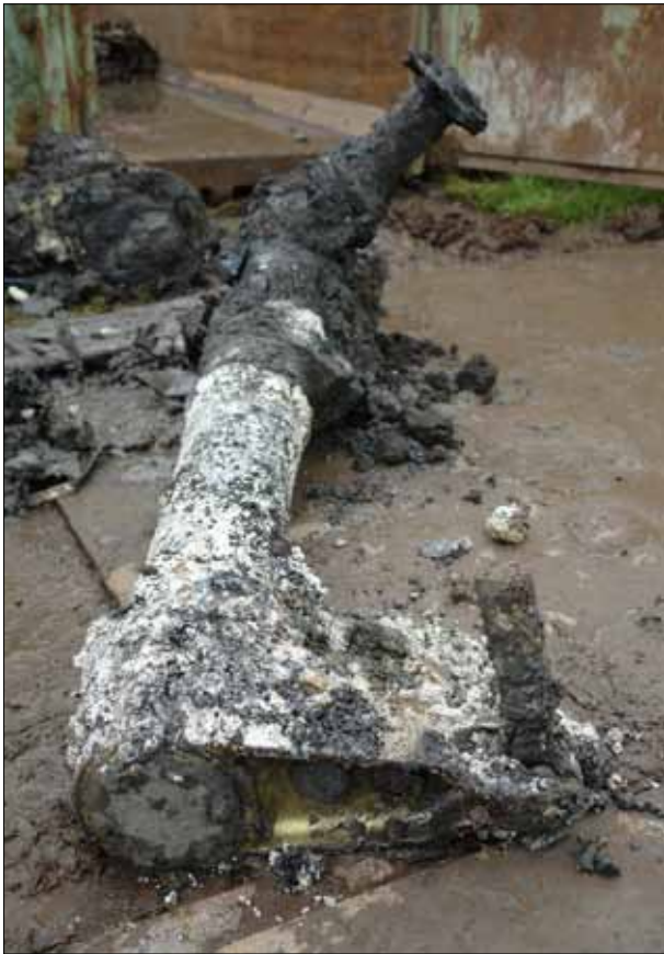
6-17 Het hoofdonderdeel van het linker landingsgestel direct na de berging. Aan de onderzijde hiervan (hier bovenaan de foto) zijn duidelijk brandsporen zichtbaar.
