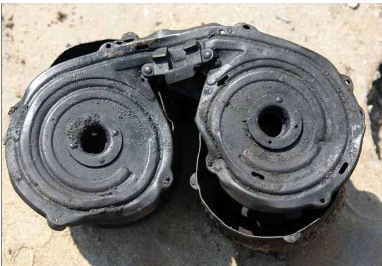
6-34 Een van de 28 MG munitietrommels die in het vliegtuig aanwezig zijn geweest. Een volle trommel bevatte 75 patronen.
