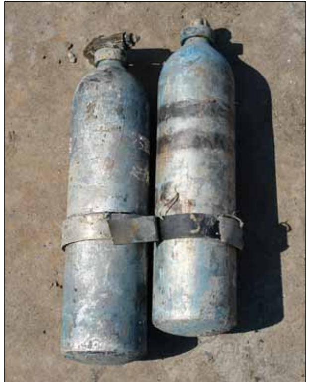
6-23 Twee zuurstofflessen, die zich vermoedelijk ergens in de cockpit bevonden.
