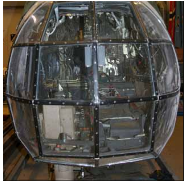
5-7 Aanzicht van de buitenkant van het neusgedeelte met langwerpige strippen. Duidelijk te zien is dat iedere strip vier klinknagels bevat. (Bron: www.ju88.net ) (Copyright: Guttorm Fjeldstad)
