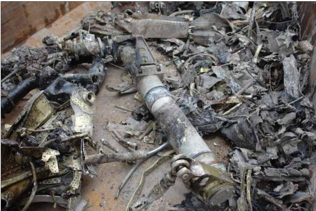
6-18 Het hoofdonderdeel van het linker landingsgestel na reiniging, temidden van de overige wrakdelen.
