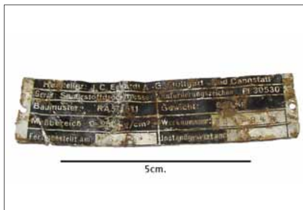
5-19 Plaatje van een 'Sauerstoffdruckmesser', vervaardigd in juni 1939.
