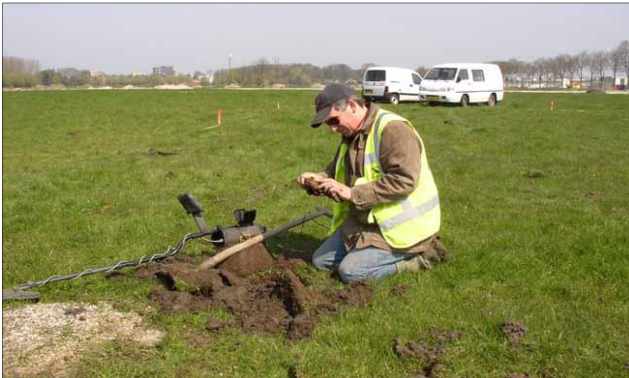
5-1 Actiefoto tijdens het non-ferro detectie-onderzoek, genomen in de richting waar de Junkers vandaan kwam. De piketpaaltjes geven de hoekpunten van de vakken weer. Op de voorgrond links ligt grind, dat de plek markeert waar tijdens het onderzoek door Saricon bv. een dieptedetectie is uitgevoerd (zie paragraaf 4.1.2).
