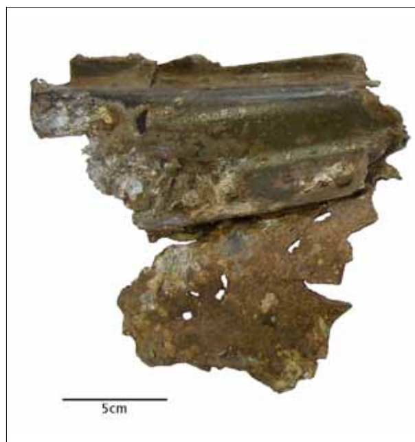
5-3 Wrakdeel van de Junkers, aangetroffen tijdens de opgraving LR54, met daarin meerdere gaatjes ontstaan door de granaatslag. (Foto: H. Lagers)
