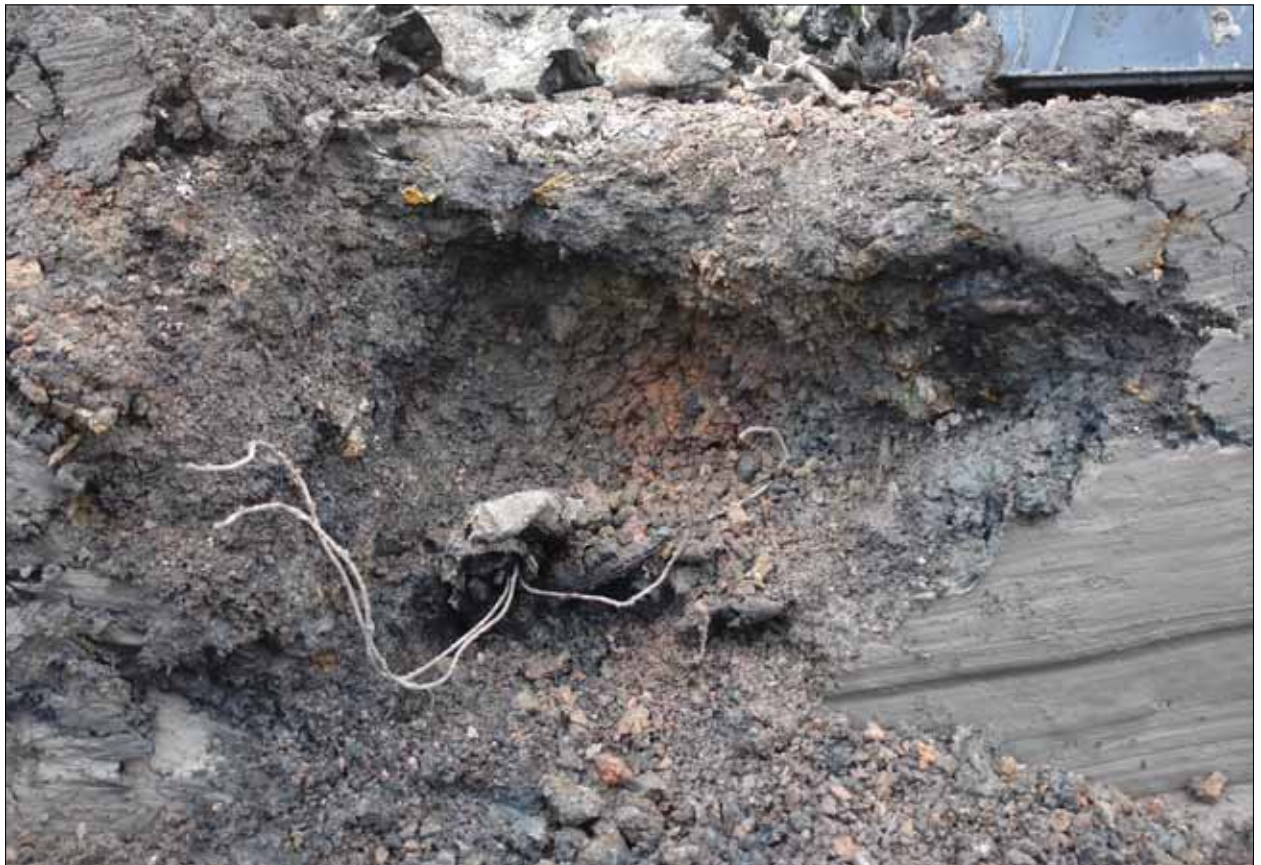
6-21 De klei onderin de inslagkrater ter hoogte van de cockpit was rood verbrand, waaruit blijkt dat er na het neerstorten vuur heeft gewoed in de cockpit.
