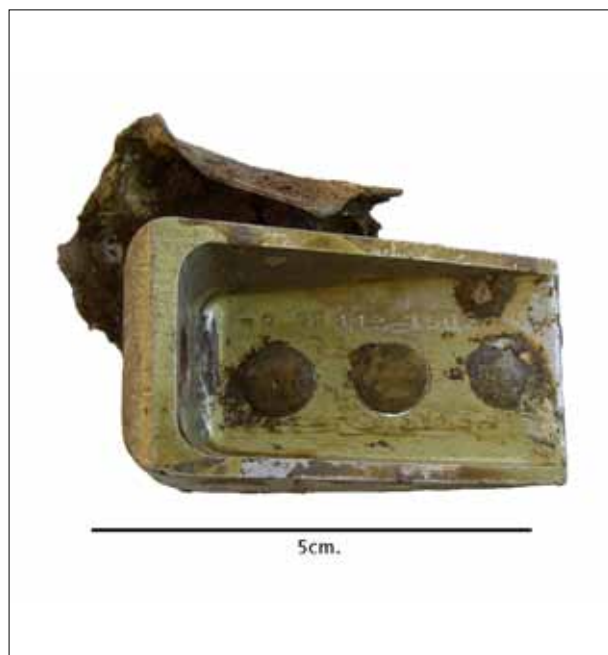
5-23 Gegoten onderdeel met daarin het nummer '88 113 150 20'. De eerste twee cijfers staan voor Junkers 88. De goudkleur geeft aan dat dit onderdeel is geanodiseerd.
