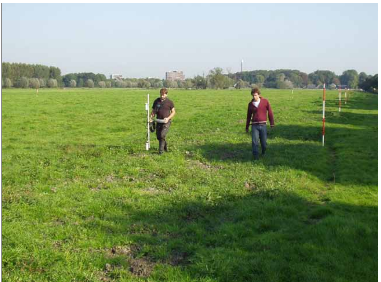
4-1 Onderzoek door Deep bv. naar de aanwezigheid van explosieven en wrakdelen met behulp van een magnetometer op 18 september 2008 (Foto: C. Rasch)
