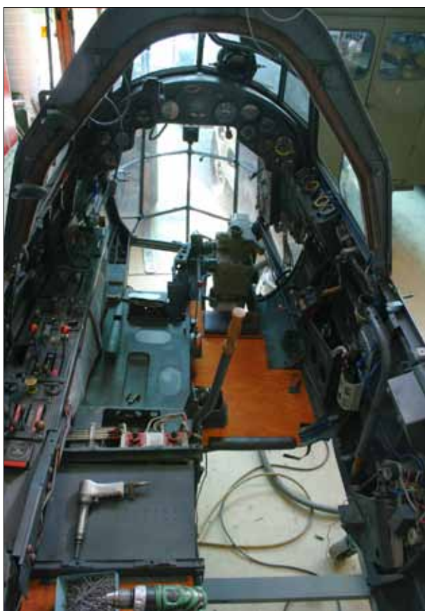
6-38 Het gedeeltelijk gerestaureerde interieur van de cockpit van de Junkers 88 A-1 van het Jonsvatnet in Noorwegen (zie paragraaf 1.3). Hierin is de houten vloerplaat met het leren kussen vóór het bommenrichtapparaat zichtbaar, alsmede één van de hendels met houten handvat. (Bron: www.ju88.net ) (Copyright: Guttorm Fjeldstad)
