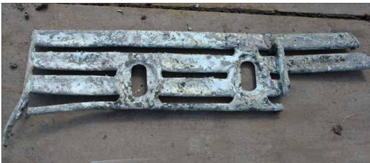
6-16 Fragment van de linker duikrem, voorzien van blauwe verf.
