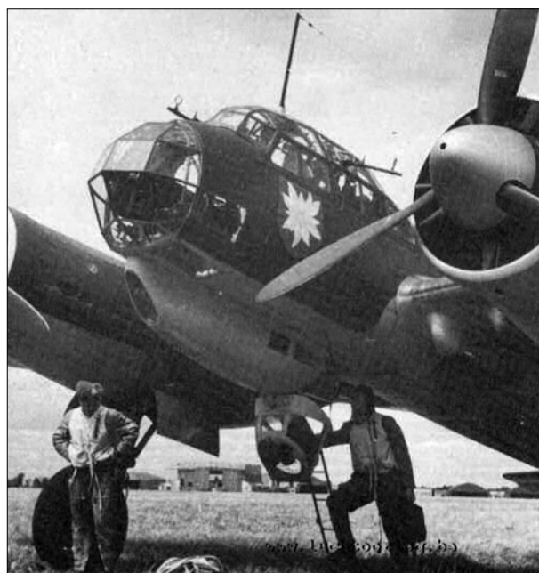
2-5 Een Junkers 88 waarvan de achterzijde van de bodemgondel is opgeklapt. Dit scharnierende luik bood de bemanning gelegenheid tot het in- en uitstappen. De ladder werd tijdens de vlucht geplaatst onder de radiowand aan de achterzijde van de cockpit.
