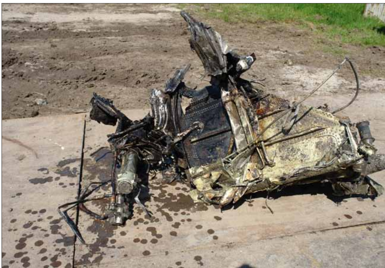
6-15 Verwongen deel van de linkervleugel, met onderdelen van het landingsgestel daaraan bevestigd.
