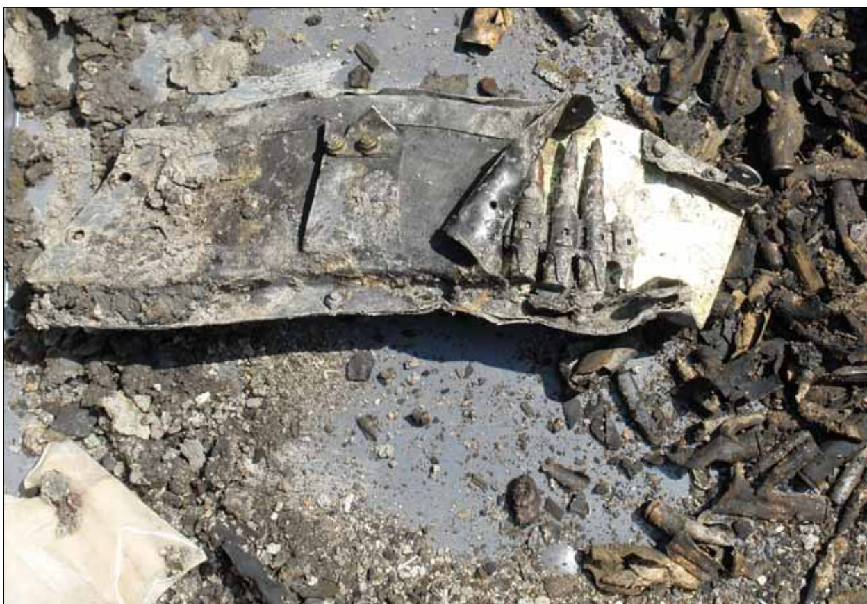
6-35 Het doorvoersysteem met daarin een band met patronen.
