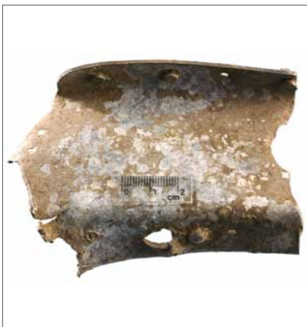
5-2 Wrakdeel van de Junkers, aangetroffen tijdens het proefonderzoek LR23, met daarin meerdere gaatjes ontstaan door de granaatslag. (Foto: H. Lagers)
