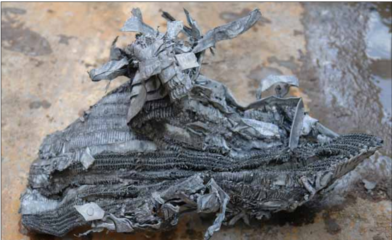
6-9 Fragment van een oliekoeler, die direct achter de propellers was gesitueerd (zie afb. 7-2).
