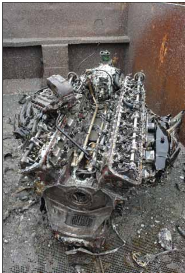
6-6 Het linker motorblok op de spreekvloer na te zijn schoongespoeten. De kleppendecksels waren van een magnesiumlegering en zijn volledig weggerot, waardoor de kleppen en nokkenassen zichtbaar zijn geworden.
