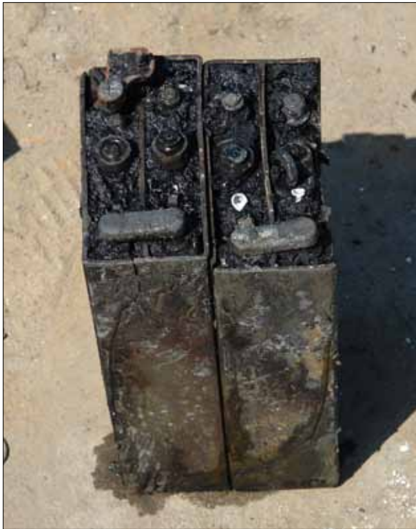
6-22 Een accu, die mogelijk onderdeel geweest is van het radiopaneel in de achterwand van de cockpit.
