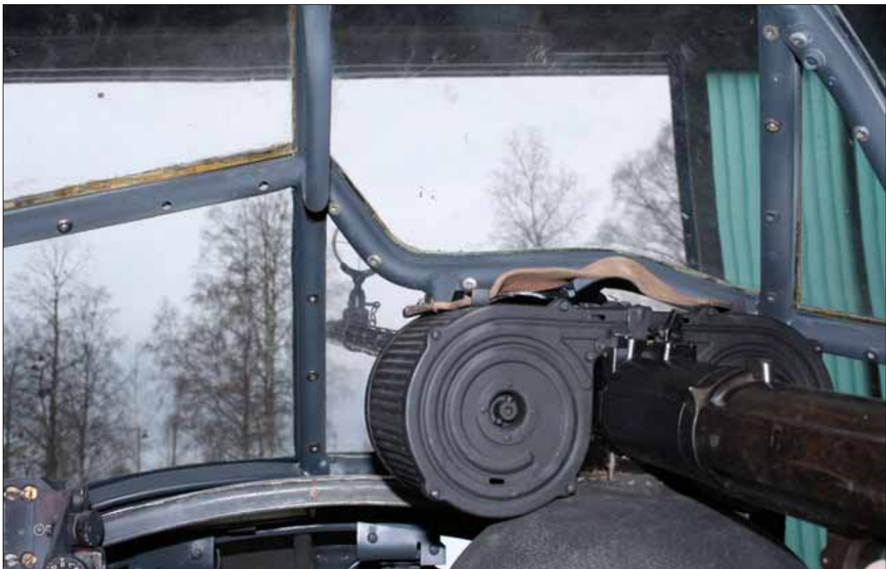
5-9 Aanzicht vanuit de cockpit over de MG naar buiten. Rondom de plexiglas ruiten zitten de massieve aluminium raamstijlen. (Bron: www.ju88.net ) (Copyright: Guttorm Fjeldstad)
