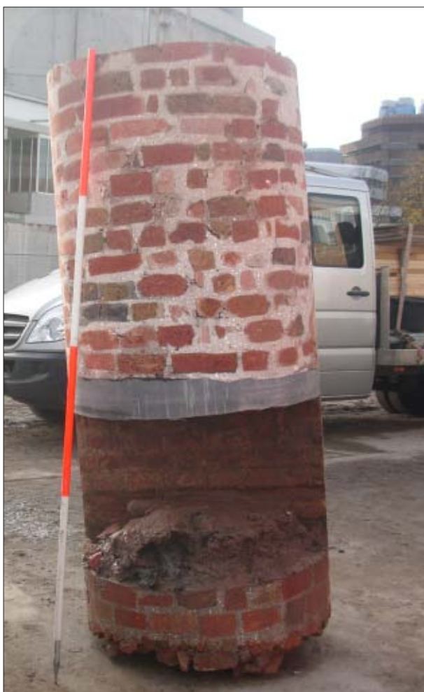
Afb. 4.9: De westelijke boorkern met een uitsnede van de afvoer.
