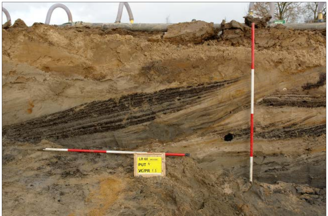
Afb. 4.17 Op deze detailfoto van het noordprofiel van werkput 4 is de (snelle) opeenvolging van sedimentatie en erosie goed te zien.
