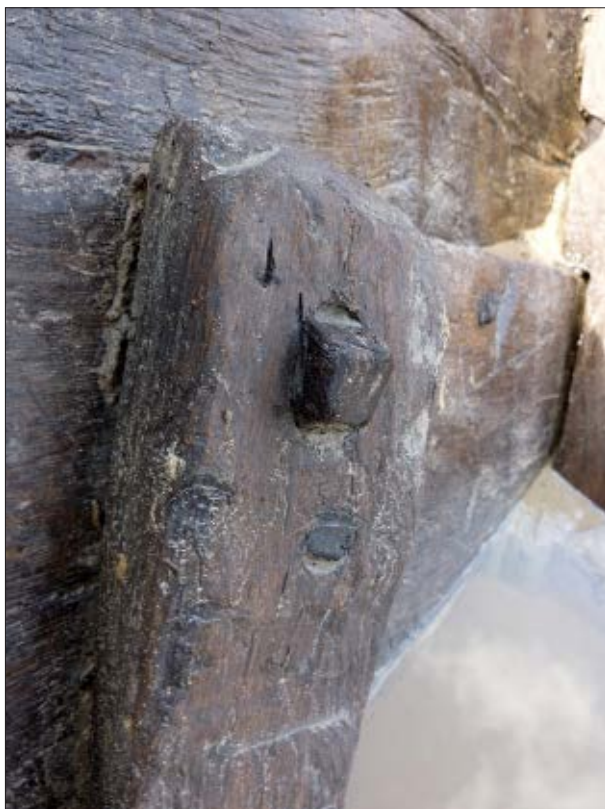
Afb. 5.15 Het zeer goed geconserveerde schip is helemaal met houten pennen in elkaar gezet; er is geen ijzer gebruikt.
