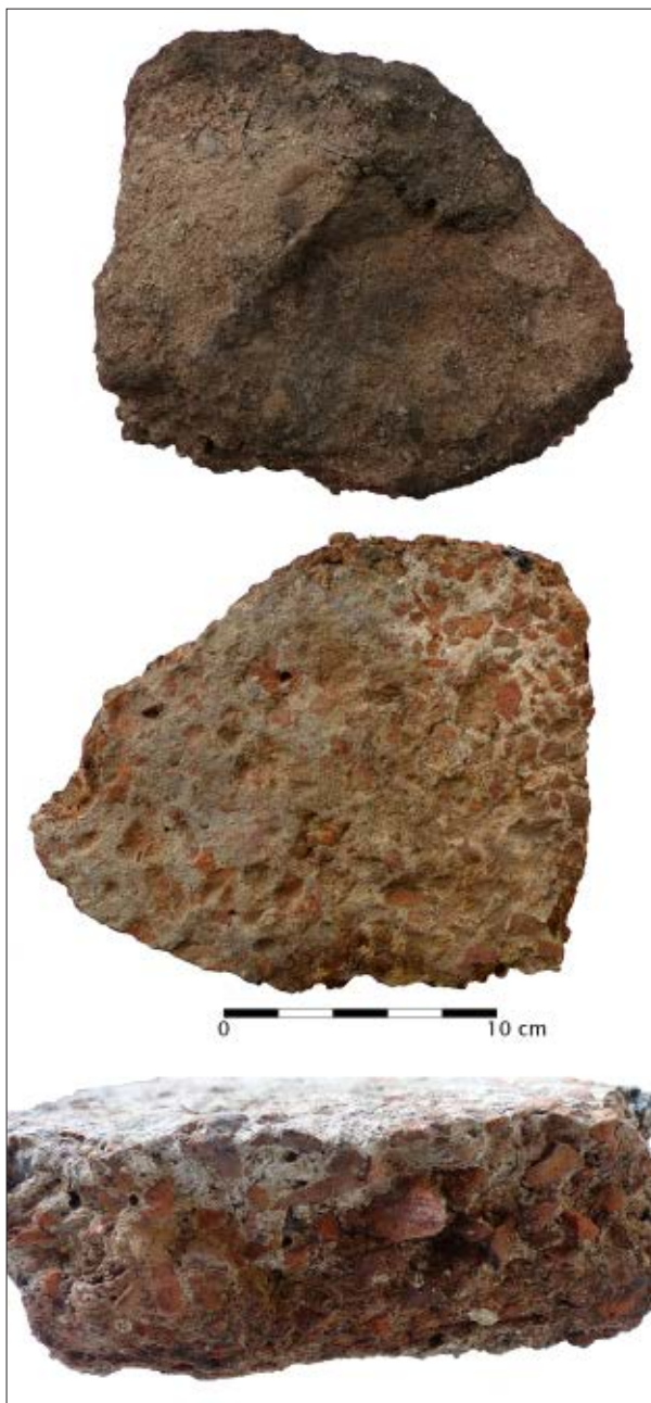
Afb. 9.1 Een groot brok Romeins beton, aangetroffen in het scheepswrak Vleuten I.
