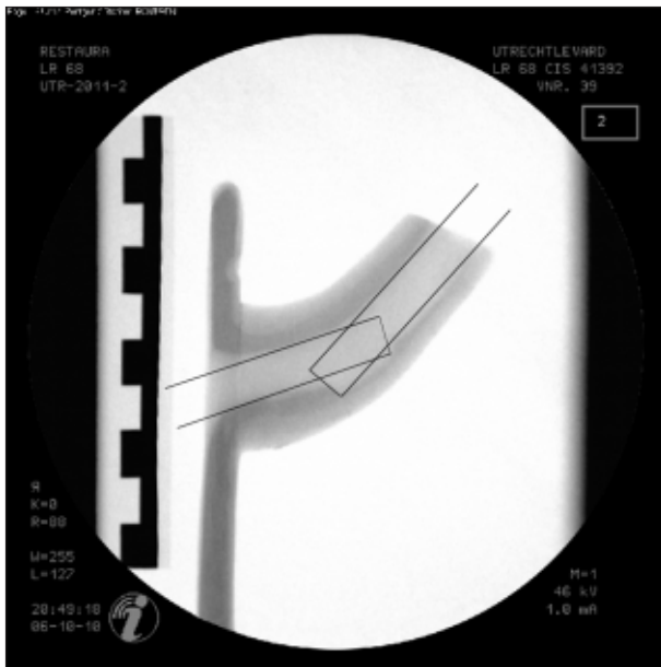
Afb. 12.20 Röntgenfoto van de tuit, waarop te zien is dat deze vanaf twee kanten doorboord is (foto: Restaura).
