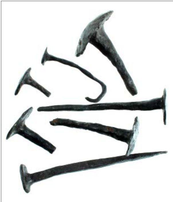
Afb. 10.1 Een selectie van nagels van verschillende afmetingen. De onderste, grootste nagel is negen cm lang.
