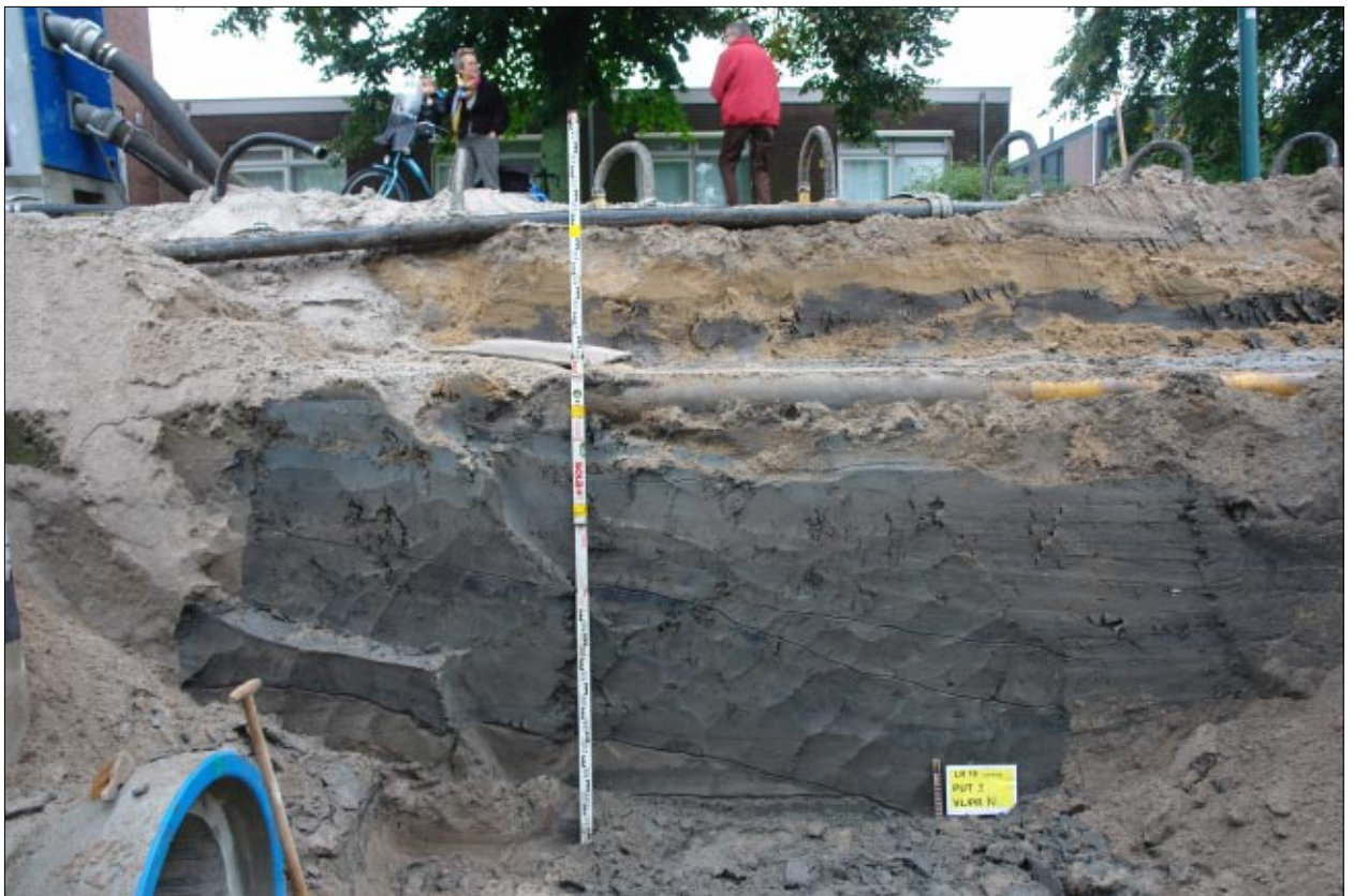
Afb. 5.6 Het westelijke deel van S2-12. De naar het oosten duikende lagen zijn goed te zien.
