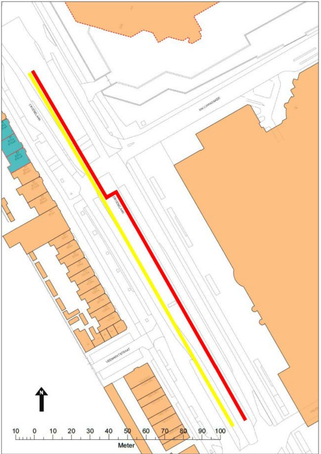
Afb. 1.2 De oude, te verwijderen buizen (in rood) en het tracé van de nieuwe buizen (in geel) (bron: Duurland 2016, bijlage 3).
