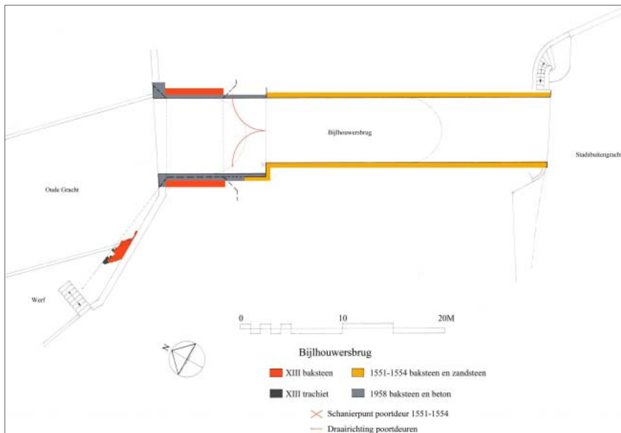
Afb. 4.1 Fasering van de Bijlhoutersbrug op basis van de opmeting uit 1997, aangevuld met de waarneming uit 2012 (tekening: H. Hundertmark).
