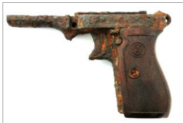
Afb. 6.24 Een pistool waarvan de slede ontbreekt: een Tsjechische CZ-27.
