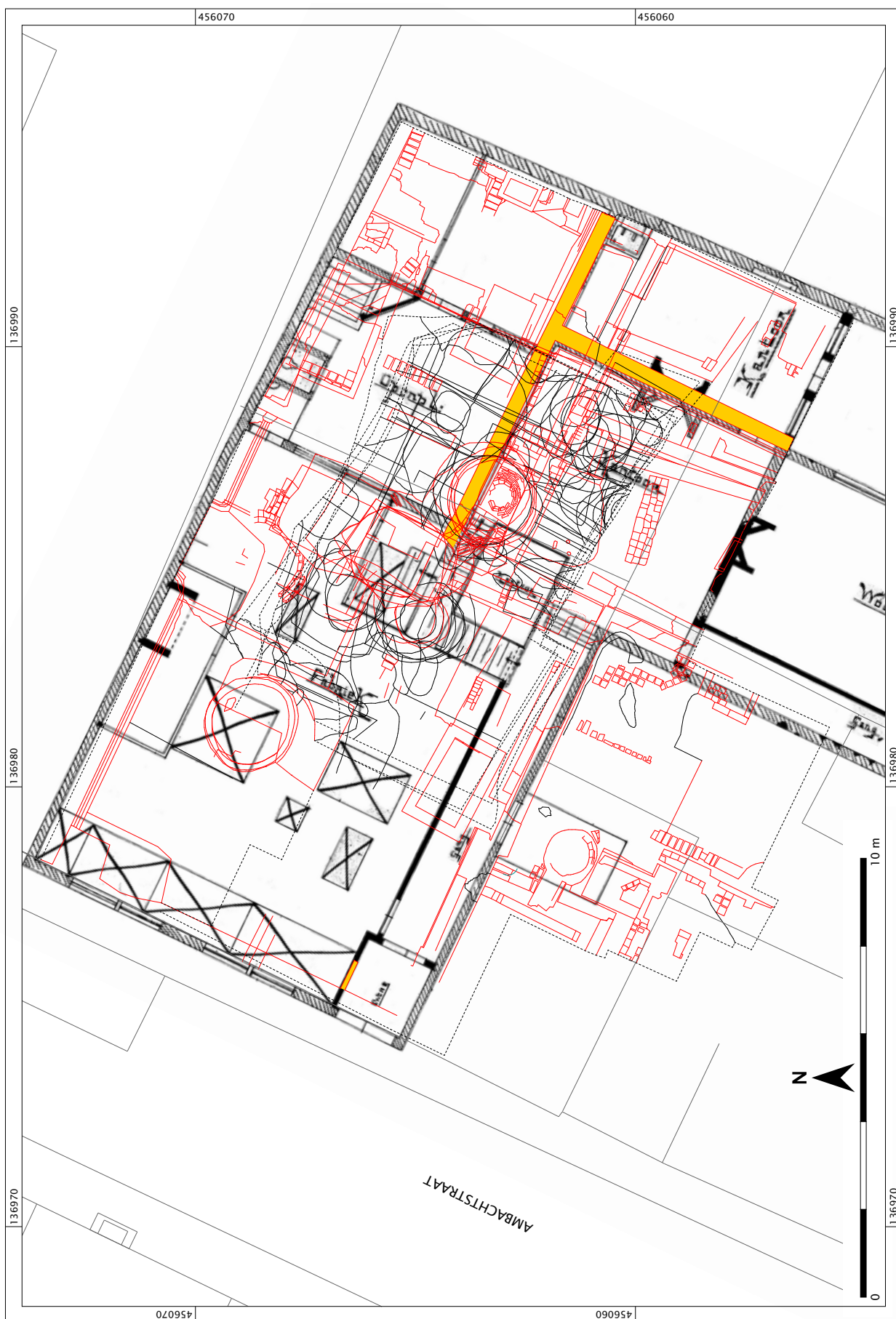
Afb. 15.19 De verbouwingsplannen van de zilverfabriek van C.L.G. Begeer uit 1907, samen met de Alle-sporenkaart van de opgraving aan de Ambachtstraat. Een aantal funderingsresten, zoals de westelijke gang, waren nog herkenbaar. Bron: Het Utrechts Archief.
