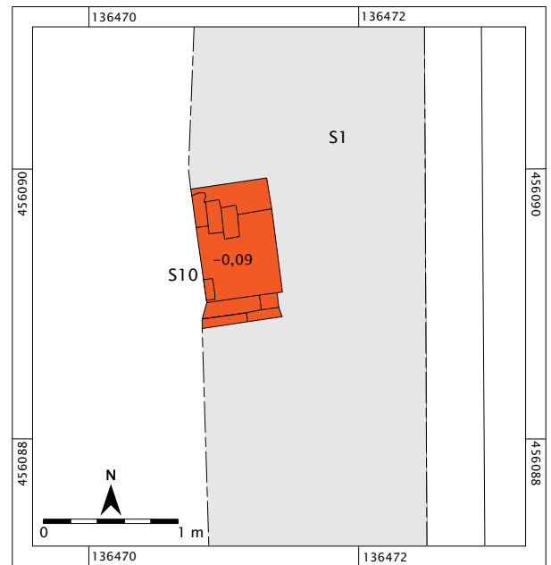
Afb. 4.3 Deelgebied midden van rak 3 west met het riool S10. De hoogtemaat van de rioolvloer is in meters ten opzichte van NAP.
