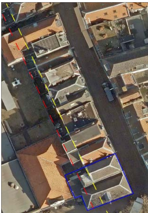
Afb. 2.6 Luchtfoto van het zuidelijke deel van de Mariastraat uit 2016. Met blauwe lijnen is het pand Mariastraat 49 aangegeven. De ligging van de voormalige oostelijke kademuur is te herkennen in de rooilijn van de achtergevels (gele onderbroken streeplijn). Ook de ligging van de voormalige immunitetsmuur is nog in de bebouwing te herkennen (rode onderbroken streeplijn). De voormalige grenssloot tekent zich hiertussen af in de vele achterplaatsjes en aanbouwsels. De meer dan 900 jaar oude grenssloot is zo nog in de huidige bebouwing bewaard gebleven.
