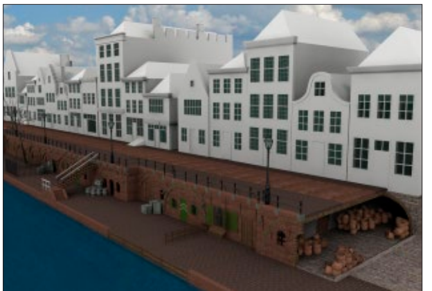
Afb. 2.1f Een aaneengesloten front (1700-1900). In de laatste periode ontstond langzamerhand het huidige beeld van de werven langs de Oudegracht. De werfkelders waren nu ongeveer even lang en werden vrijwel allemaal afgesloten met een bakstenen muur met een deur en enkele vensteropeningen. Nog steeds waren de werven particulier bezit, dus van een openbare straat was geen sprake. Veel stenen borstweringen bovenaan de straat werden vervangen door ijzeren balies (hekwerkjes).
