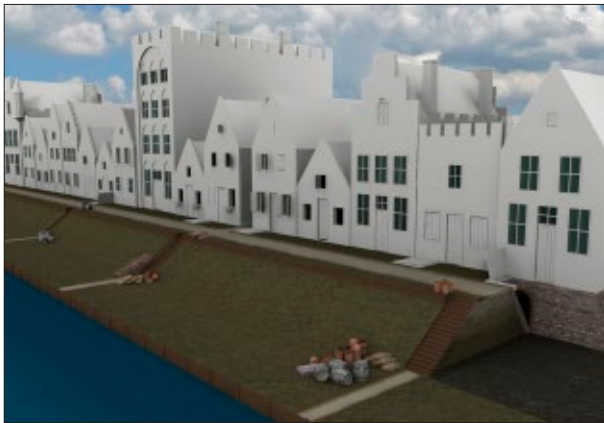
Afb. 2.1 De ontwikkeling van de werven en werfkelders in zes fases. (reconstructies: D. Claessen; bron: De Kam en Rampart 2007) Afb. 2.1a De oever op (1000-1175). De ontwikkeling van de werven en werfkelders is in verschillende fases te verdelen. In de eerste daarvan was er weliswaar al een behoorlijk hoogteverschil tussen de laaggelegen kades en de straat met de panden eraan, maar van werfkelders was nog geen sprake. Alle handelswaar moest eerst de oever worden opgesleept om vervolgens via de keldertrap weer naar beneden te worden gebracht naar de huiskelder van het grachtenpand.
