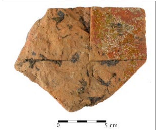
Afb. 6.10 Deel van een 'moedertegel' waaruit kleine plavuisjes gebroken konden worden (vnr. 5). De tegel is voor het bakken ingesneden om het in stukken breken makkelijker te maken.
