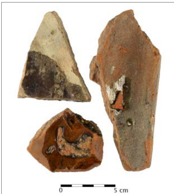
Afb. 6.6. Fragmenten van dakpannen, zogenaamde golfpannen, met glazuur op het oppervlak en op het oude breukvlak. Aan het glazuur kleven nog stukjes roodbakende aardewerk.
